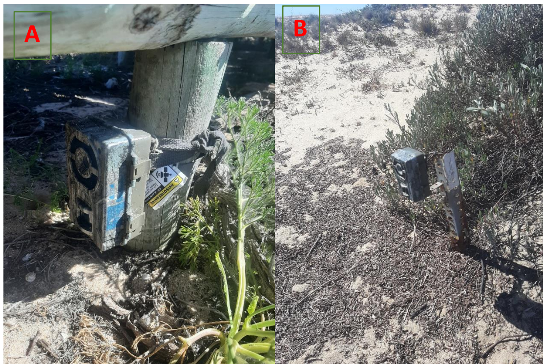
Figura 4: Armadilha fotográfica instalada no passadiço (A) e instalada em estacas de ferro (B)
